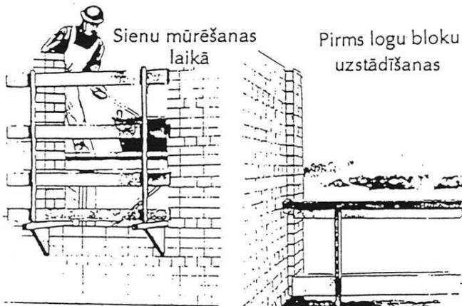
Рис.14. Огораживание оконных проемов
